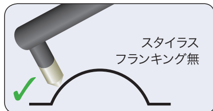
図 2: 角度のついたゲージヘッドがフランキング問題を解決
